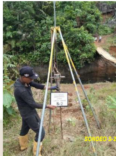
Fotografías 7 y 8. Exploraciones de campo y estratigrafía Sondeos S-1 y S-2.
